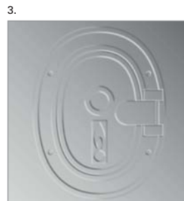
1. Vorlage, 2. Vektorisierung auf 2 Ebenen, 3. Visualisierung der Höhen und Schattenkanten mittels Relief-Effekt in Photoshop, 4. Geprägtes Produkt
